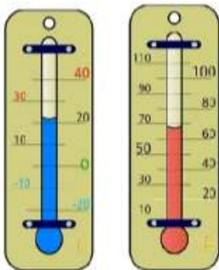
**El termómetro**, es un instrumento que se usa para medir la temperatura. Los termómetros tradicionales, utilizan la **dilatación** y la **contracción térmica**. Aprovechan el cambio de volumen de un líquido, ya sea cuando se enfría o se calienta.
