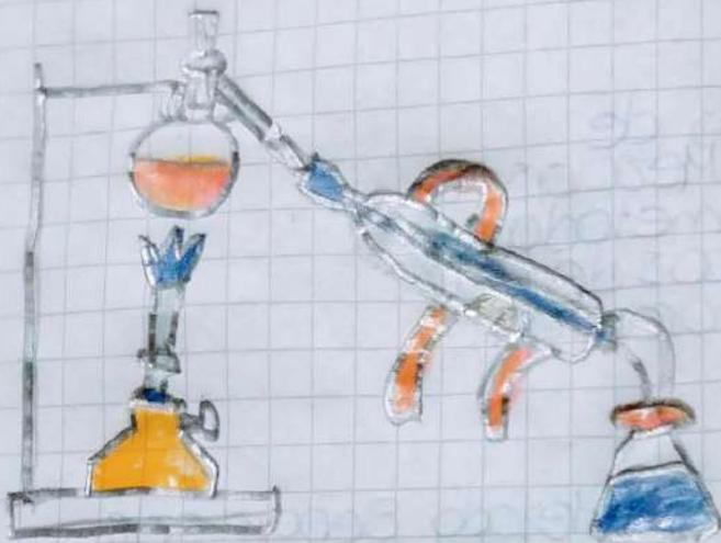
Se puede usar para separar mezclas de líquidos con puntos de ebullición bastante distantes o para recuperar un solvente.
