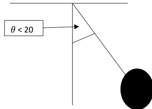
**Figura 1.** Péndulo simple con Angulo menos que  $20^\circ$
