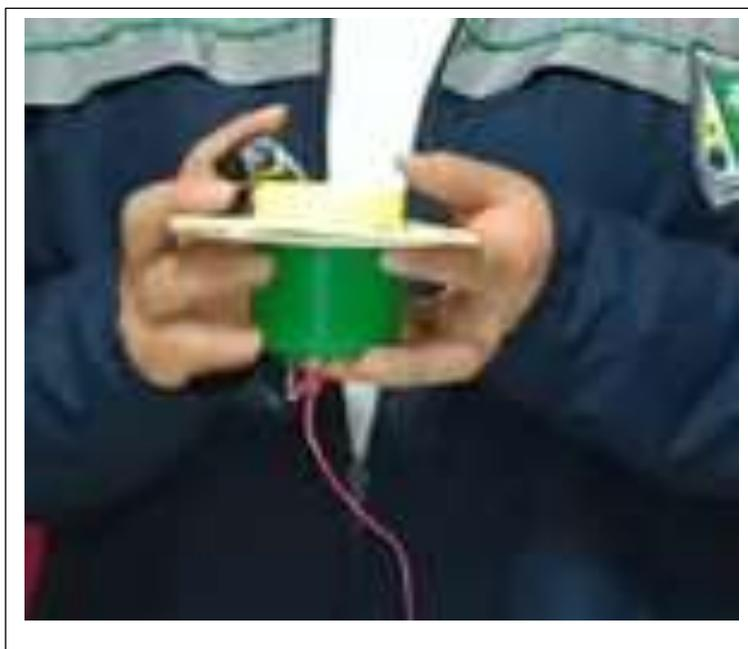
7° En el medio del recorrido del cable de color rojo, entre la pila y el motor-led cortamos e instalamos el interruptor, luego lo pegamos la tapa grande por la parte brillante del cd.
