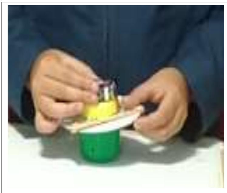
6° Conectamos los cables del motor y led, a la pila respetando los colores de los cables, son los que indican la polaridad del circuito, cable negro es Negativo (-), cable rojo Positivo (+).
